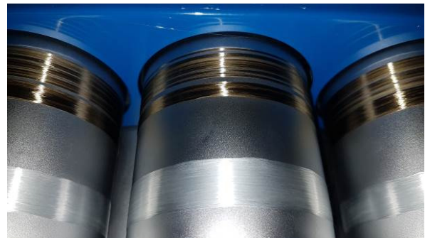
Parallele Verarbeitung von Basalt- und Glasfasern im Faserspreizprozess
