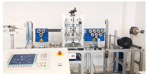
Versuchseinrichtung zum Spreizen von Basaltfasern
