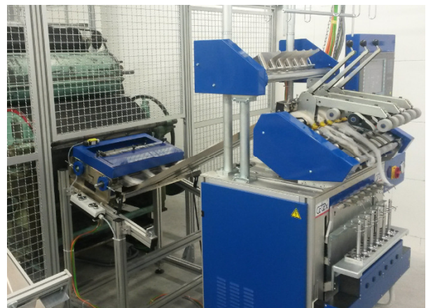
Versuchsanlage (Krempele – Florteiler - Spinntester)
