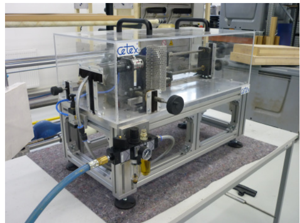
Trenneinrichtung zur Herstellung der endlosfaserverstärkten Einleger
