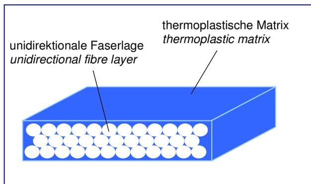
*Schematischer Schnitt durch das thermoplastische Halbzeug Ce-Preg<sup>®</sup>*
