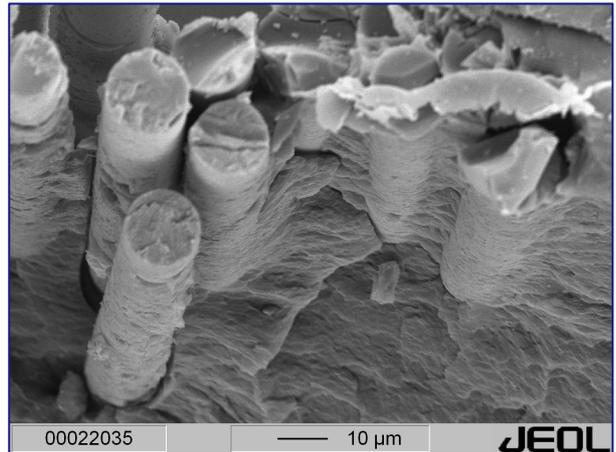
Hybridwerkstoff mit gutem Fließverhalten und guter Anhaftung der Matrix - REM-Aufnahme (Vergrößerung 1000x)
