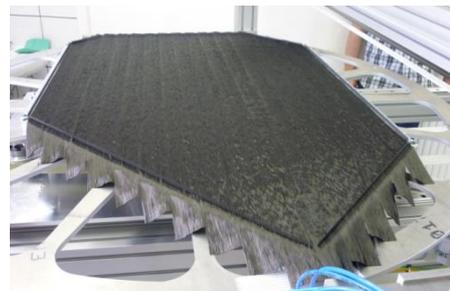
Die Arbeiten unseres Institutes konzentrierten sich dabei auf das Legen belastungsgerecht aufgebauter endkonturnaher Verstärkungsstrukturen aus trockene CF-Faserbändchen (Rovings) und aus vorbebinderten Verstärkungsfaser-Rovings.
