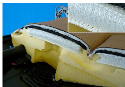
Prototyp: Abstandsgewirke in einem Fahrzeugsitz der Audi AG (Foto: Cetex)
