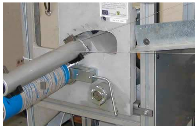
Ein Wickler mit intermittierendem Antrieb imitiert den Fadenbedarf der Webmaschine
