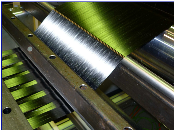
Homogenes Faserband nach der Ausspreizzone Homogeneous fibre tape after the spreading zone
