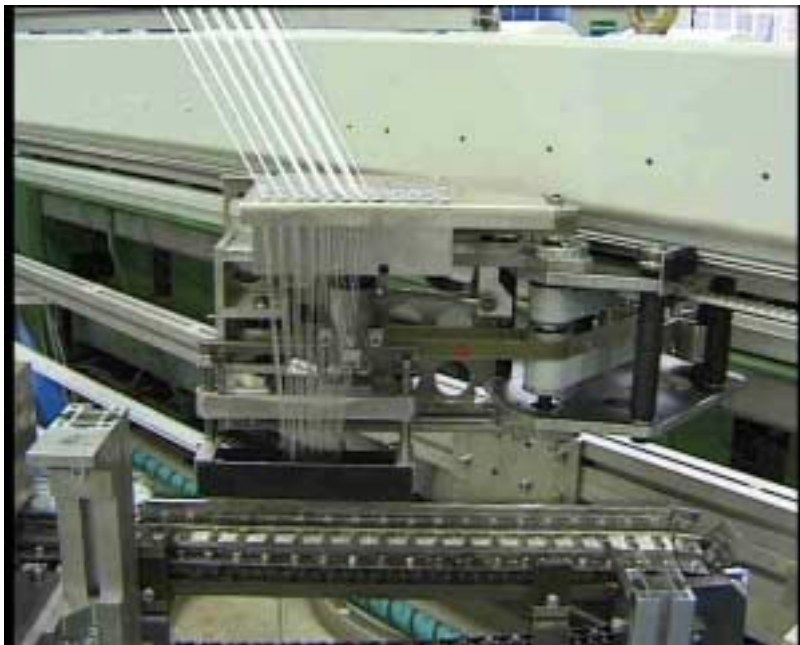
Bild 2: Gesamtansicht Schußleger in Einstellung -45^\circ
