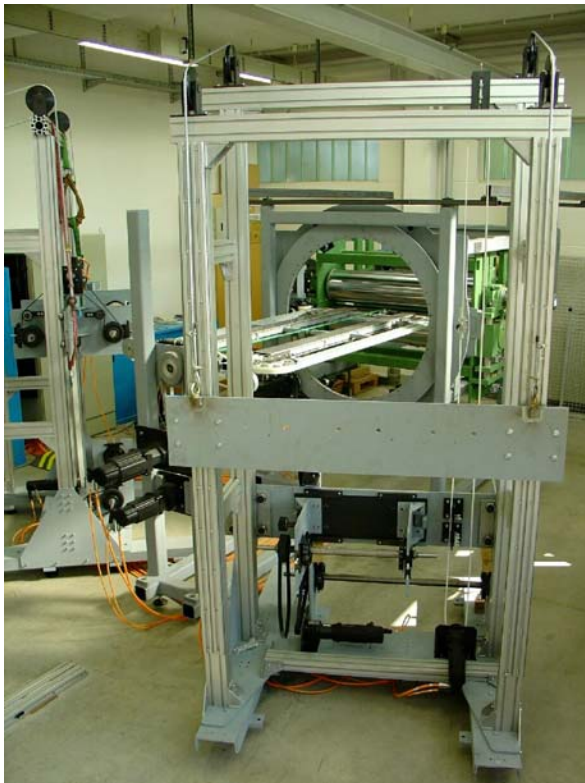
Abb.: Versuchsanlage zur Herstellung von Multiaxialgelegen im Faltwickelverfahren
