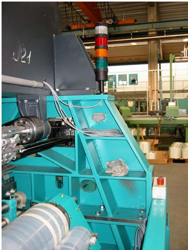
Rechte Gestellwand mit geschweißten stark verrippten Stahl-Wandteilen
