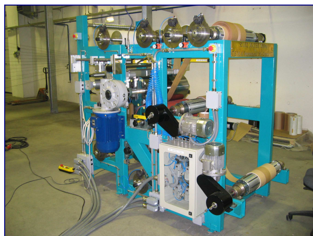
Bild 3: Anlage zur Herstellung von Scheibenspulen (Fa. TEMA, Italien)
