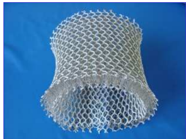
Silvertex®-3D-Abstandsgewirke mit offener Struktur
