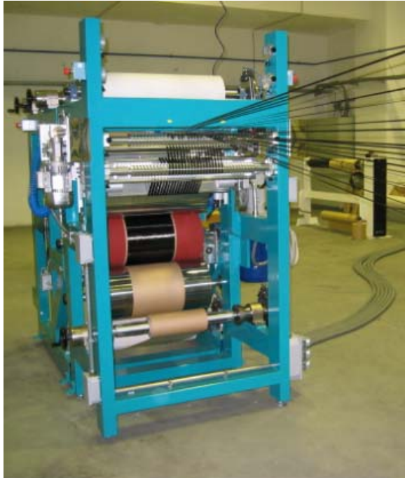
Abb. 2: UD-Anlage zur Herstellung vorfixierter unidirektionaler Materialbahnen
