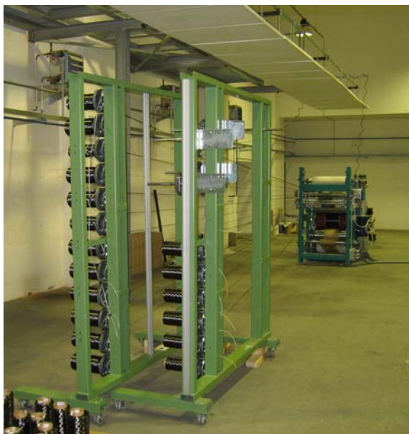
Abb. 3: Ablaufgatter für Faserrovings an der UD-Anlage
