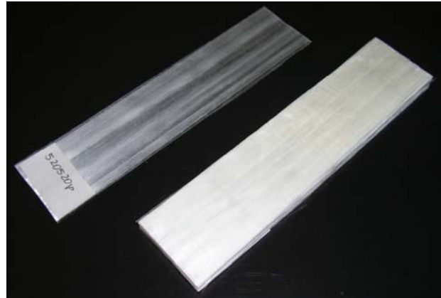
Abb. 1: Neue thermoplastische Prepregs (Ce-Preg ® ); rechts: Aufbau der Faserbändchen; links: UD-Faserbändchen und Mehrschichtverbund
