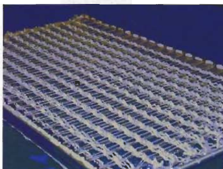
Bild 2 Detailansicht des gitterförmigen, beidseitig 0°-90°-verstärkten 3D-Gewirkes
