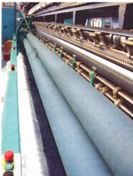
Bild 1 Raschelmaschine 5431 mm Walzenlänge
