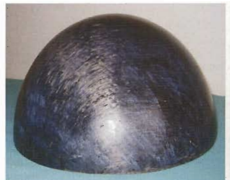
Bild 4 Faserverbundbauteil (Negativform - konkav) mit faltenfreier Außenseite, Halbkugeldurchmesser 298 mm, Höhe 149 mm; Handlaminat aus Epoxidharz L20 + Härter EPH 161 mit 4 Lagen vordrapiertem Multi-axialgelege
