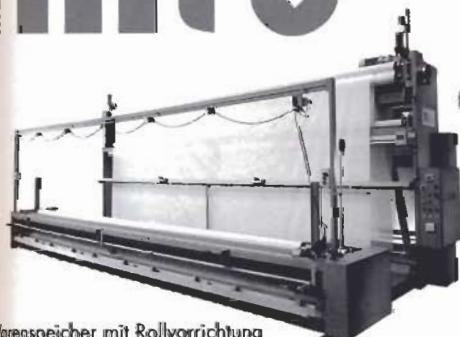
Warenspeicher mit Rollvorrichtung fabric accumulator with batching motion
