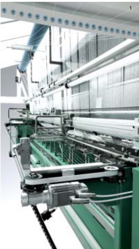
1 Raschelmaschine mit Parallelschusseintrag (Detailansicht), KARL MAYER Malimo Textilmaschinenfabrik GmbH Raschel machine with parallel stitching element (detailed view), KARL MAYER Malimo Textilmaschinenfabrik GmbH
