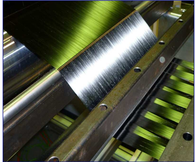
Homogenes Faserband nach der Ausspreitzzone Homogeneous fibre tape after the spreading zone
