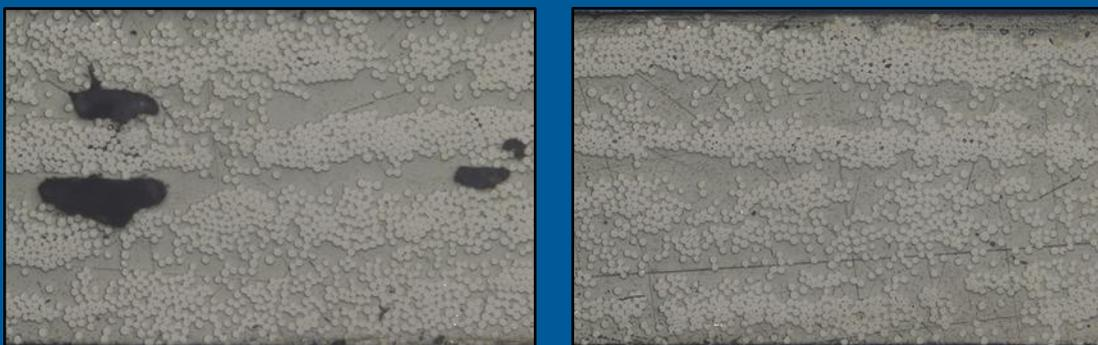
Abbildung: Schlibbild Organoblech, Bild links: unvollständig imprägniert, Bild rechts: vollständig imprägniert
