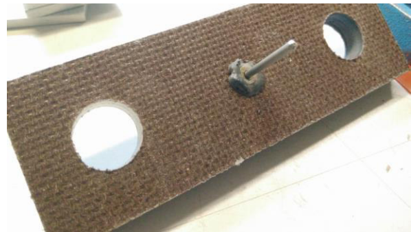
Bindniet nach dem Eintrag durch das Heißnietverfahren
