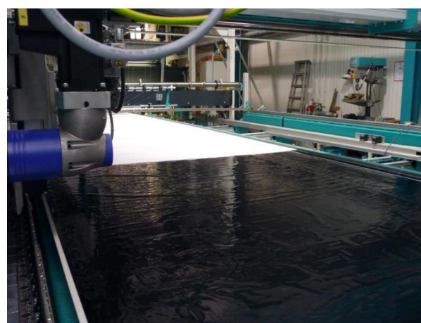
Legung der PP-Folie auf Glasfaserlage
