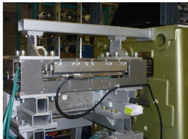
Legeschieneantrieb mit neuem absoluten Längenmesssystem
