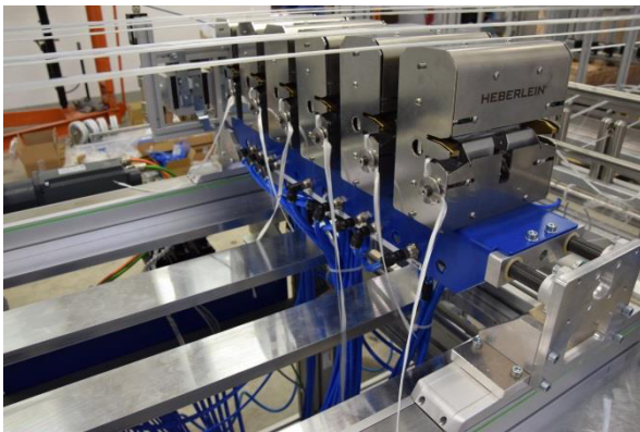
Spleißerleiste am ARWeS-Versuchsstand
