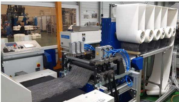
6-fach-Abwickler mit Streckwerk und Einzug in Kaschieranlage
