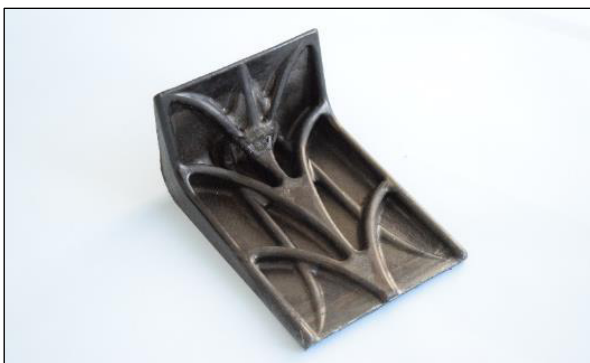
Sandwichaufbau aus rCF-Hybridvliesstoff mit UD-Decklagen
