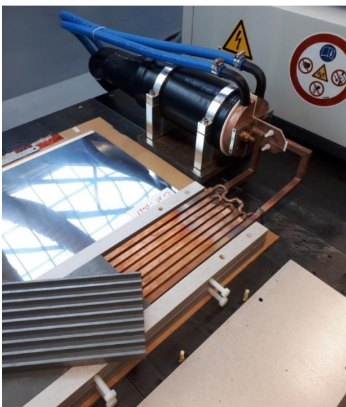
Abbildung 2: Induktor mit Schwingkreis, Generator und Kernmaterial
