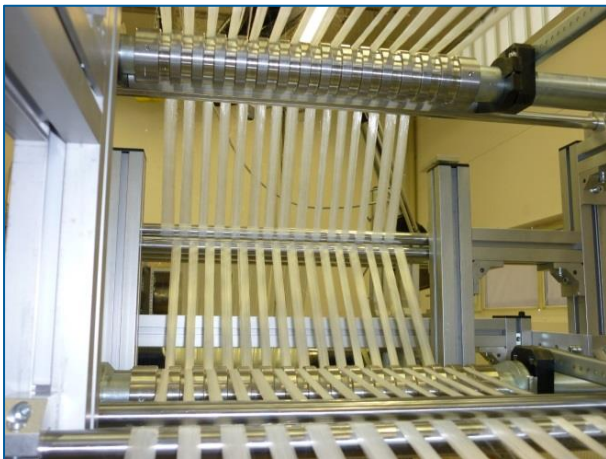
Beide Fadenführungsebenen mit Teilungsstäben und Zusammenführung der beiden Fadenführungsebenen
