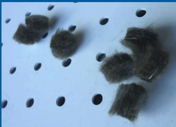
Abbildung 1: Deformationen durch unsachgemäße Lagerung
