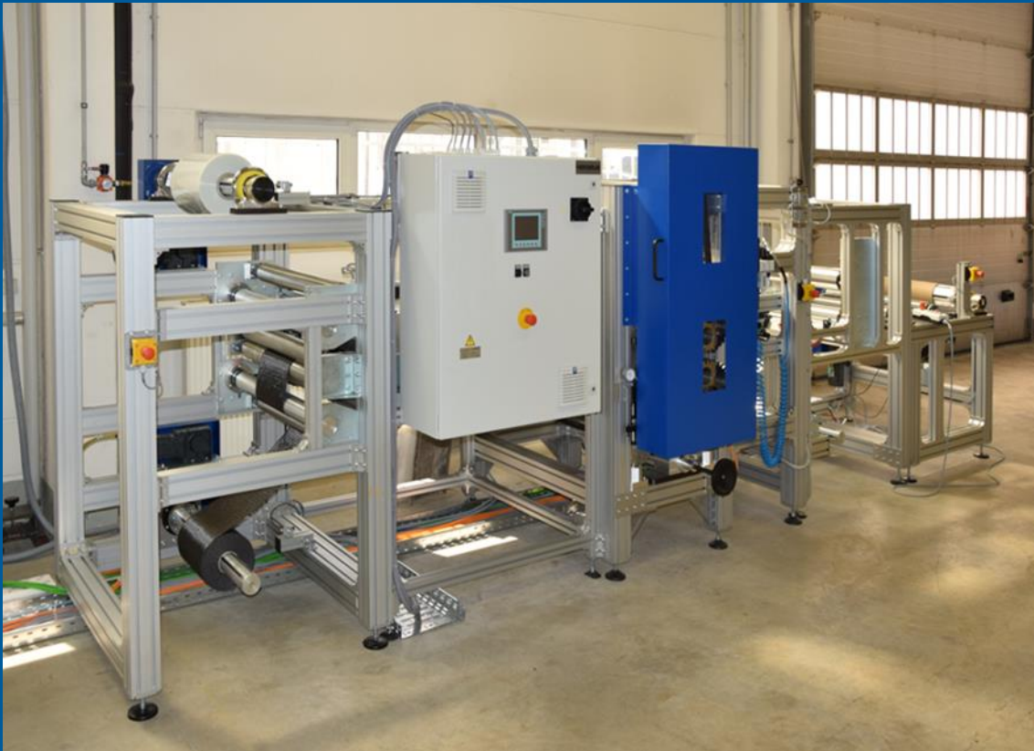
Abbildung 2: Versuchsanlage zur Herstellung teilkonsolidierter und matrixhybrider Halbzeuge
