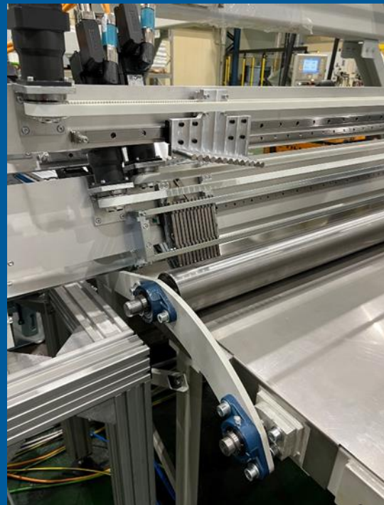
Abbildung 2: modulares System zur lastpfadgerechten Ablage von (Verstärkungs-)Fasern
