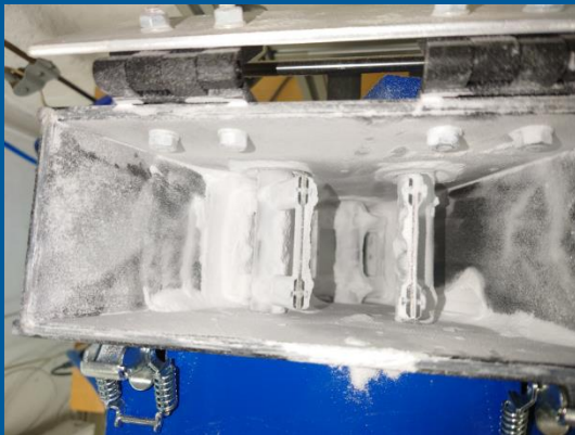
Abbildung 2: Umwälzen des Pulvers mit dem Rührwerk
