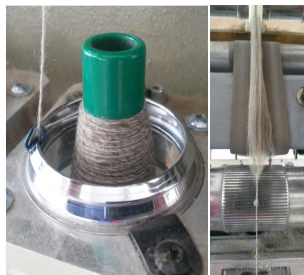
Ring-Läufer-System mit BA/PES-Garn / Hauptverzugzone im Streckwerk
