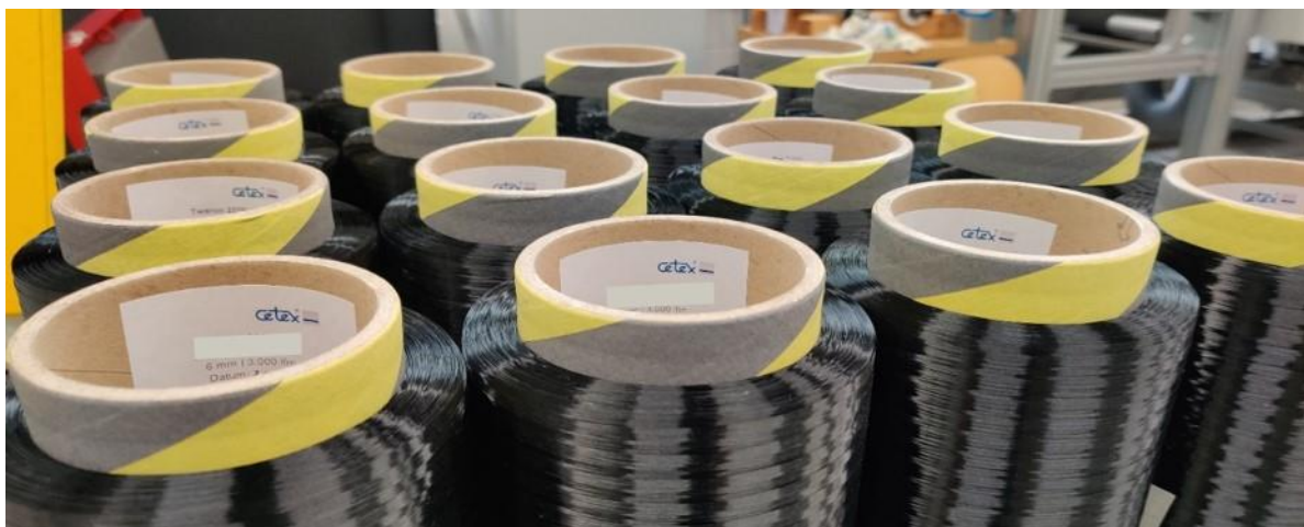
Bild/Figure: Fixierte Aramidfaserrovings als Kreuzspulen / Fixed aramid fiber rovings as cross-wound bobbins
