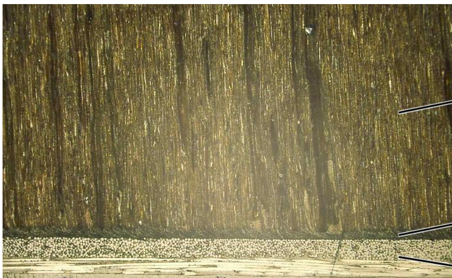
Aufbau eines Holz-Glas-Prepregs/Structure of a wood glass prepreg
