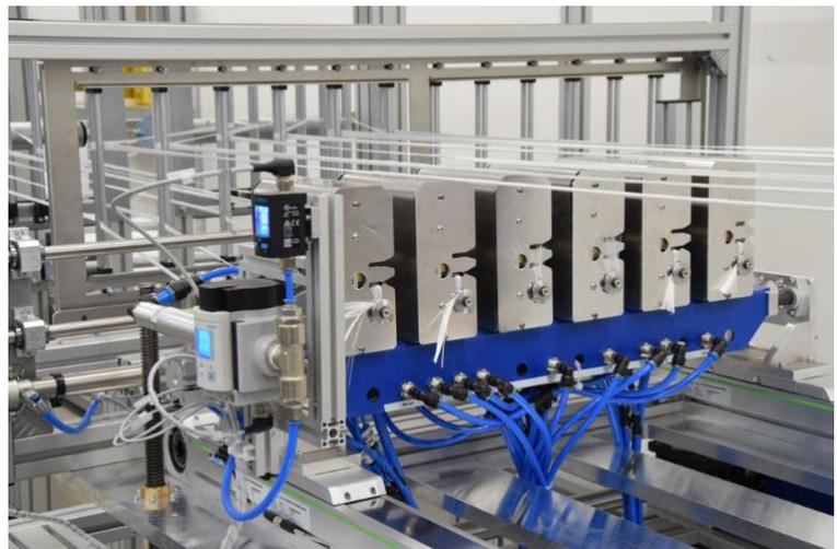
Roving-Wechsel-System / roving change system
