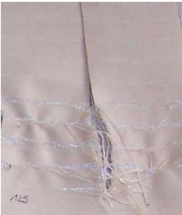
*Rissverlauf bei einem weiterreißfesten Planenmaterial mit PVC-Beschichtung (PET-Grundgewebe, PTFE-Flottungsfäden)*
