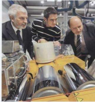
aus der Kooperation mit der Professur für Strukturleichtbau und Kunststoffverarbeitung. Zur Umsetzung der gestellten Aufgaben bietet ein gut bestückter und gezielt ausgebauter Maschinen- und Anlagenpark umfassende Möglichkeiten. Die jüngste Erweiterung beinhaltet eine Labor-Flachfolienanlage.
