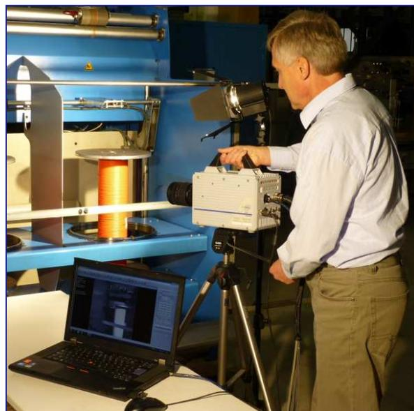
Herr Dipl.-Ing. Markert mit dem Highspeedsystem Photron Fastcam SA5 an einem Versuchsstand
