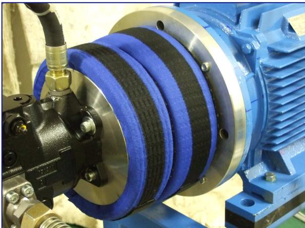
*Versuchsstand zur Schalleistungsmessung an einem Pumpenträger*
