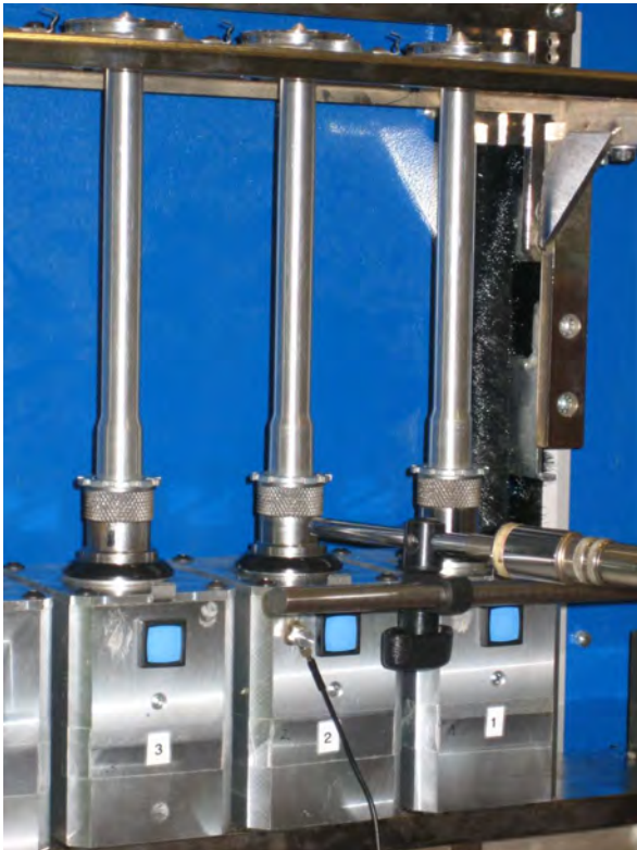
Teilansicht einer Spindelbank
