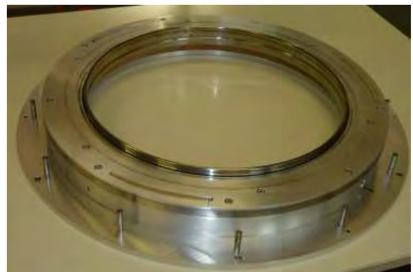
Lagerdeckel mit Magnetlagerring einschließlich Zwirnring
