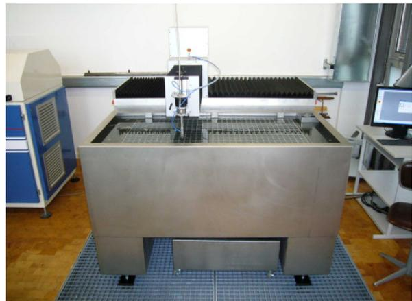
Anlage zum Abrasiv-Wasserstrahlschneiden
