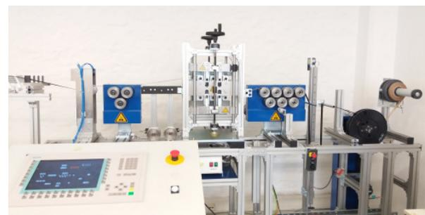
*Versuchseinrichtung zum Spreizen von Basaltfasern*
