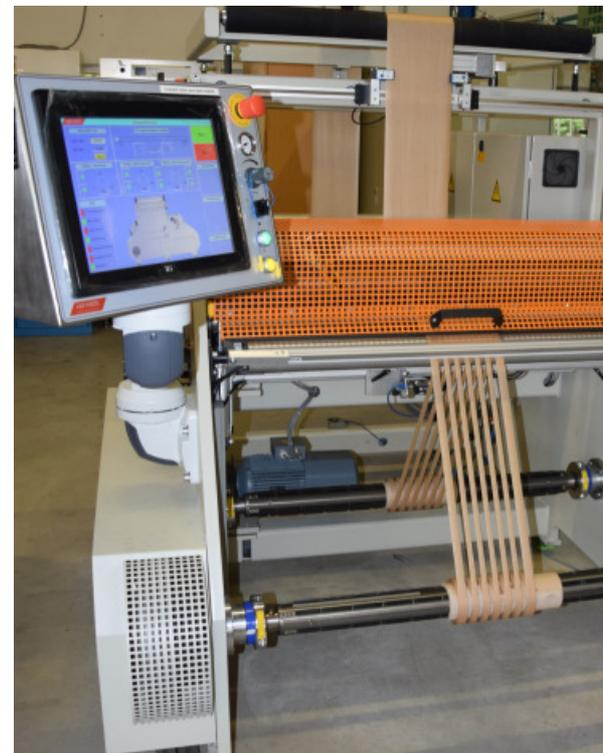
Längsschneide- und Umspulgerät „LS-RR 1000“ der Fa. A&M KINZEL Siebdruckmaschinen Ltd
