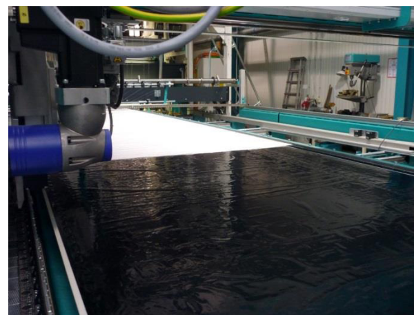
Legung der PP-Folie auf Glasfaserlage
