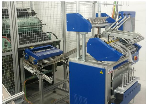
Versuchsanlage (Krempele – Florteiler - Spinnester)
