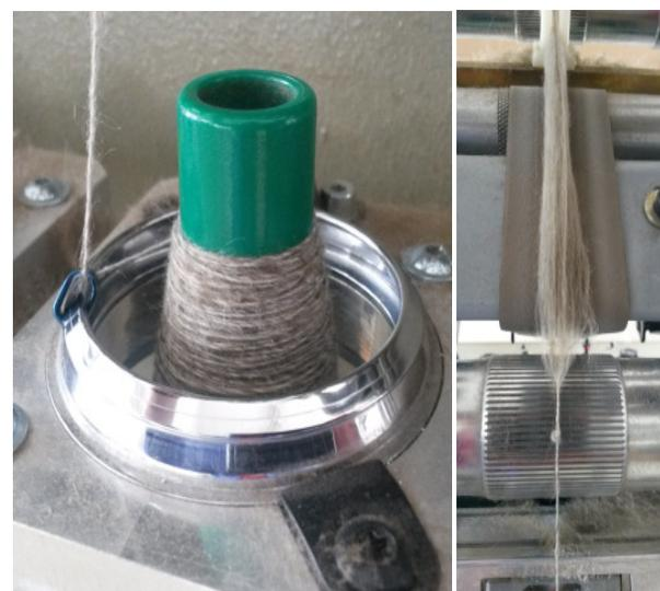
*Ring-Läufer-System mit BA/PES-Garn / Hauptverzugzone im Streckwerk*
