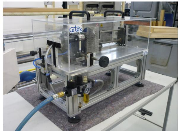
*Trenneinrichtung zur Herstellung der endlosfaserverstärkten Einleger*
