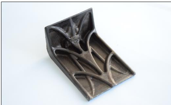
Sandwichaufbau aus rCF-Hybridvliesstoff mit UD-Decklagen
