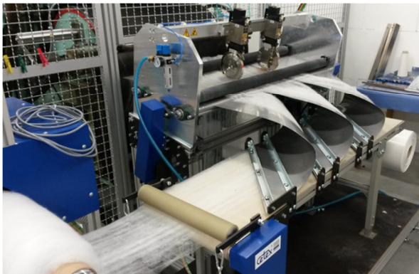
Krempelabzug mit Florteiler, Umlenkeinrichtung und Aufwickelstation
