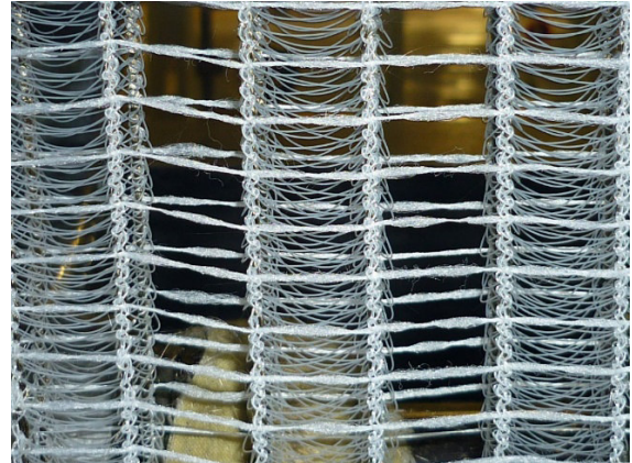
Musterstruktur (gestreckt) in der Wirkmaschine
