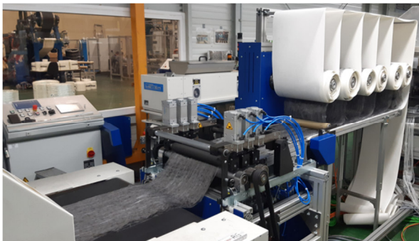
6-fach-Abwickler mit Streckwerk und Einzug in Kaschieranlage
