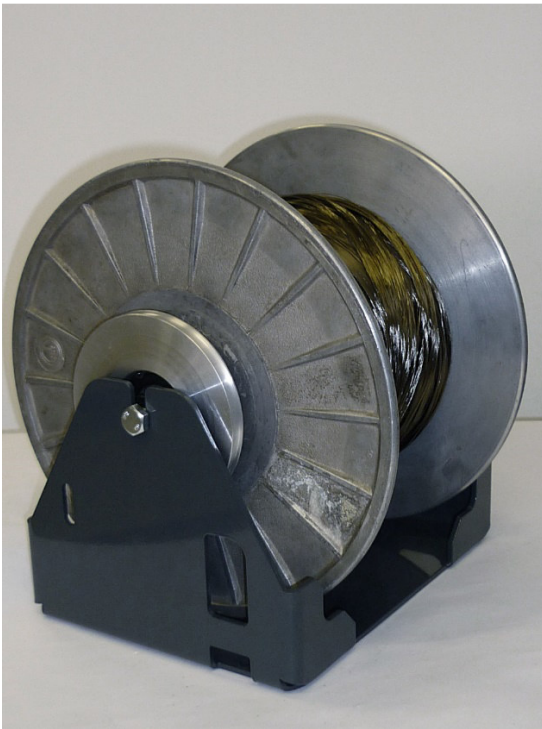
Neue Einzelaufnahme mit 8-Zoll-Kettbaum
