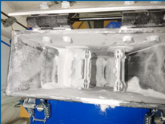
Abbildung 2: Umwälzen des Pulvers mit dem Rührwerk
