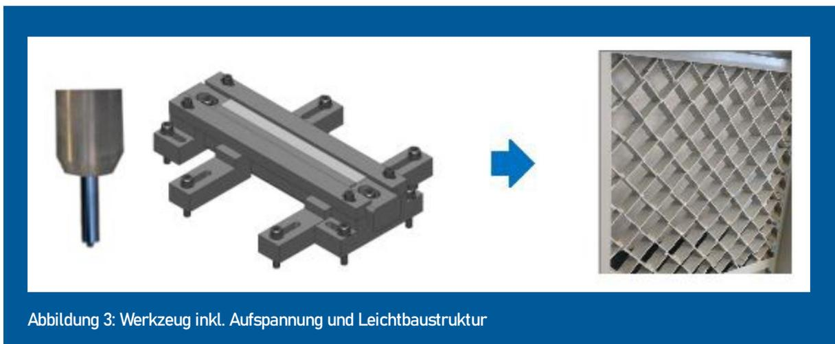
Abbildung 3: Werkzeug inkl. Aufspannung und Leichtbaustruktur
