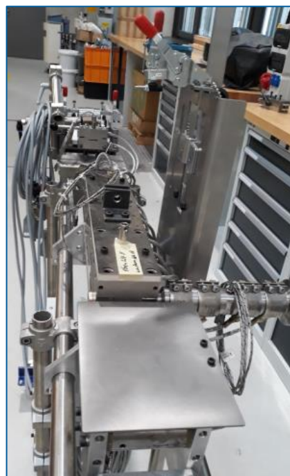
Montierte Versuchsanlage aus Imprägnierwerkzeug und Kalibrierwerkzeugen (Fotos: thermoPre e.V.)
