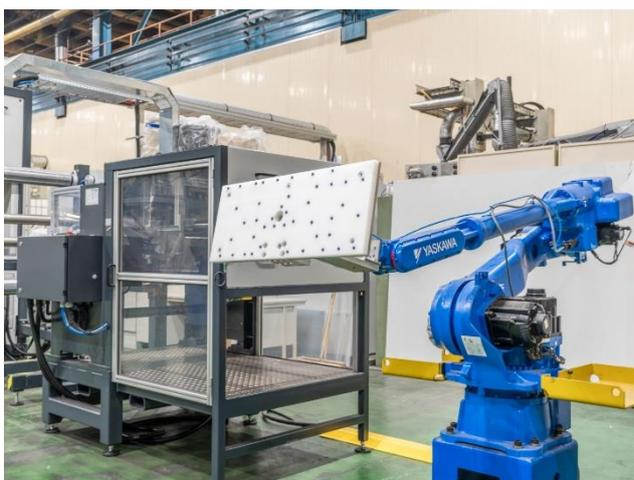
Entnahmesystem an der Intervallheißpresse
