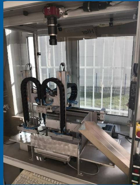
Abbildung 3: Kamerasystem zur Qualitätsüberwachung mit integrierter Handlingeinheit
