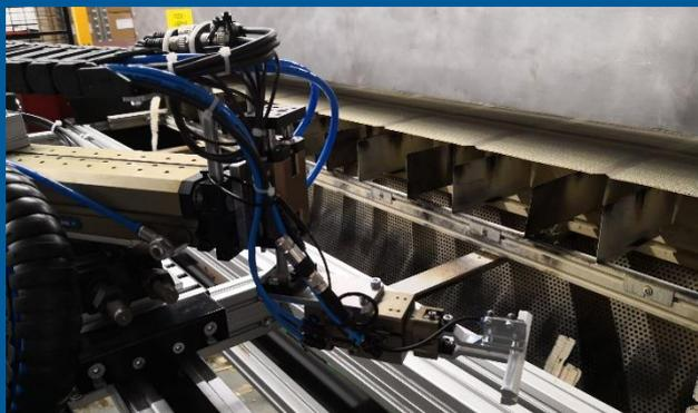
Abbildung 2: Handlingsystem an der Laserstrahlschneideinheit
