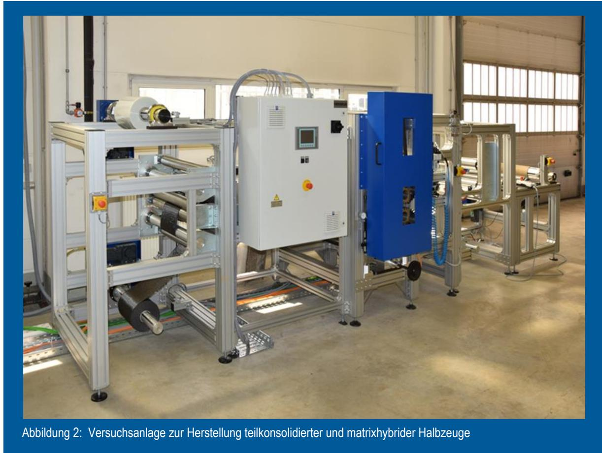
Abbildung 2: Versuchsanlage zur Herstellung teilkonsolidierter und matrixhybrider Halbzeuge
