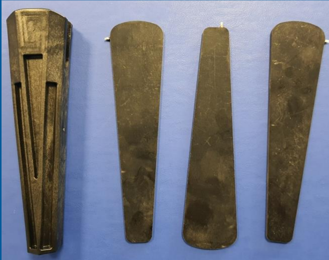
Abbildung: Mit Glasfasergewebe verstärkte Seilendverbindung
