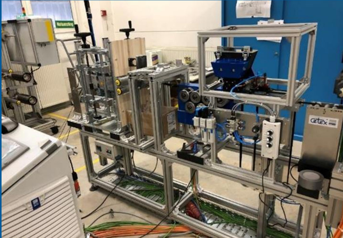
Abbildung 2: Anlagenkomponente zur Imprägnierung von Slimpregs
